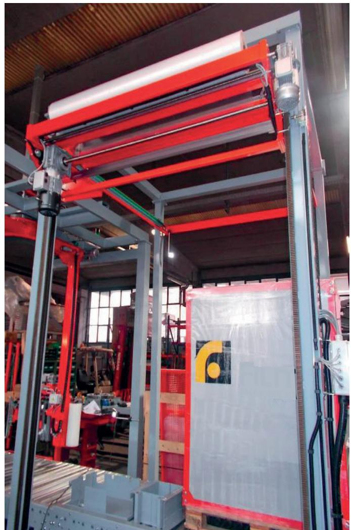
Dispositivo automatico per la copertura superiore del pallet (antipolvere) con struttura indipendente.
